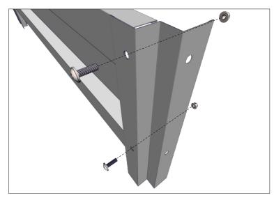
1. Прикрутите ножки к стенкам через заводские отверстия, ножки должны располагаться снаружи грядки
