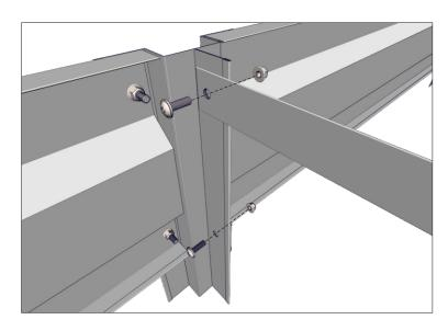
2. Соединяйте стенки с прикрученными ножками между собой, при помощи винтов. В местах соединения ножек между собой прикрутите стяжки.
